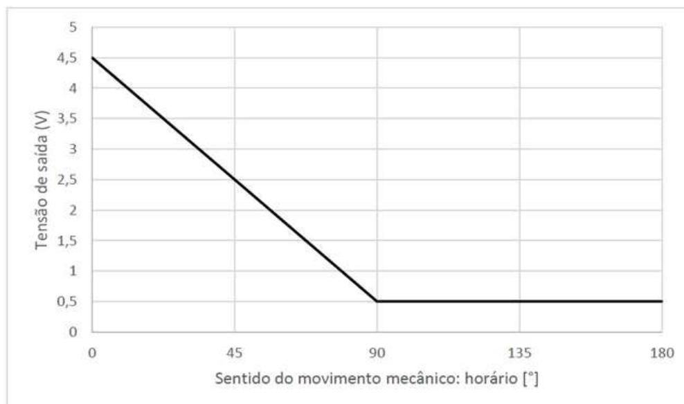
Figura 8 - Faixa de Medição de 90°, Centro da Faixa de Medição em 45°, Sentido de incremento anti-horário, saída 0,5 a 4,5 V
